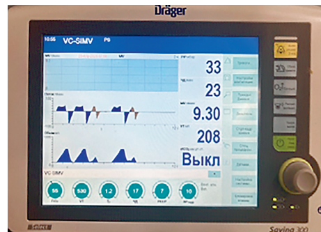
Рис. 3. Аппарат Dräger Savina 300 с установленной фракцией кислорода во вдыхаемой газовой смеси \text{FiO}_2 75–80%
