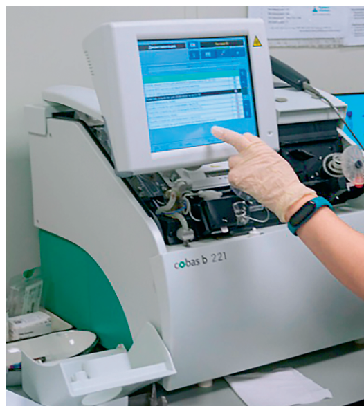
Рис. 6. Мультипараметровый анализатор газов крови, электролитов, оксиметрических параметров и метаболитов Cobas b221 (Roche, Швейцария). (Фотография с официального сайта НИИ скорой помощи им. И.И. Джanelидзе)
